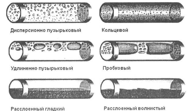
Рис. 3. Режимы течения в горизонтальных трубопроводах [1]
